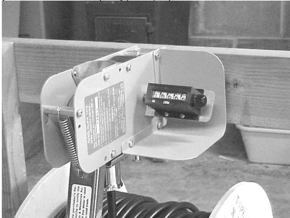
Rysunek 11 Miernik długości kabla firmy Hykon 1410 z zamontowaną 500 stopową (152m) szpulą kabla RG-213.
